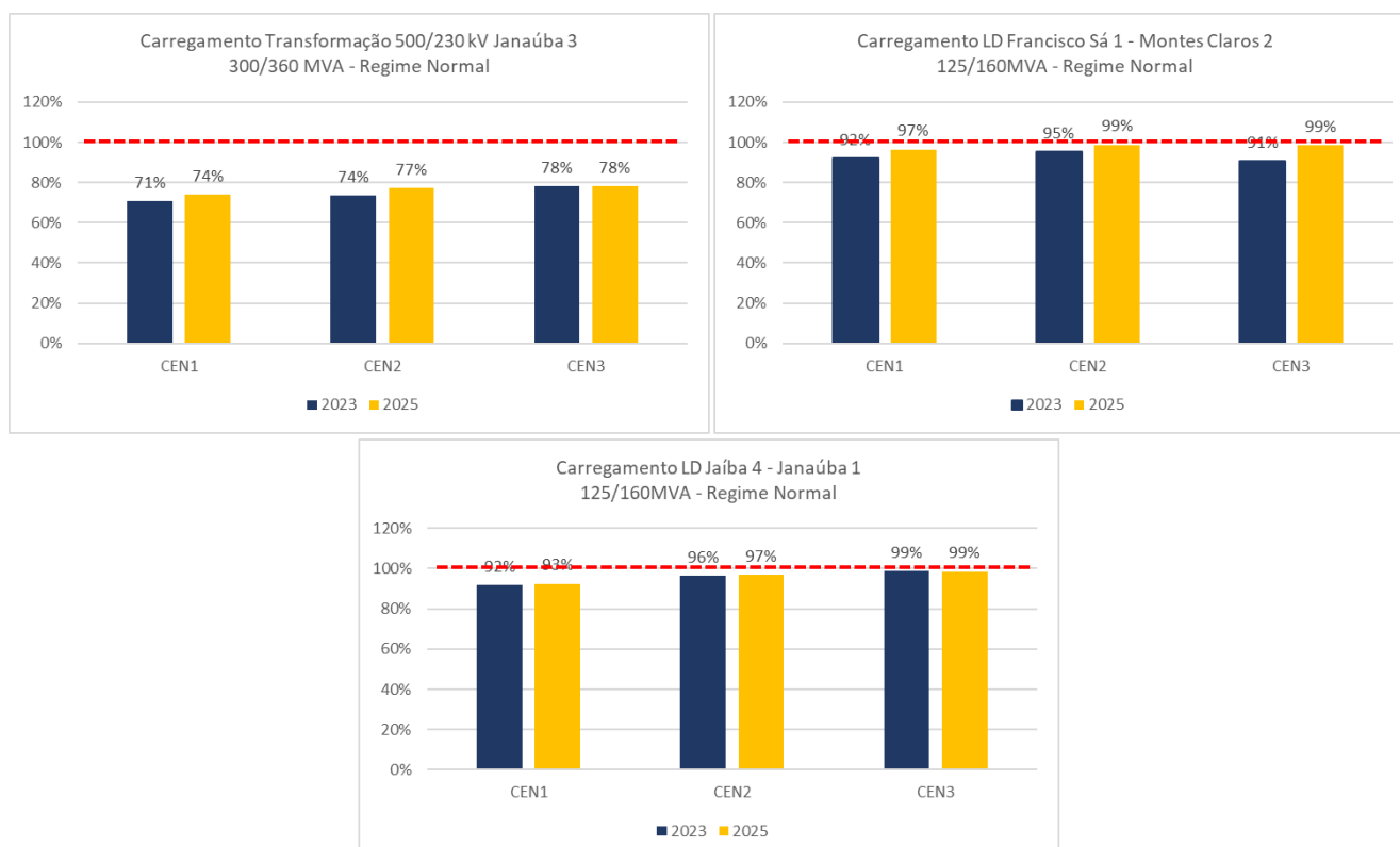
Figura 7-3 – Carregamentos em condição normal – com 4º TR
