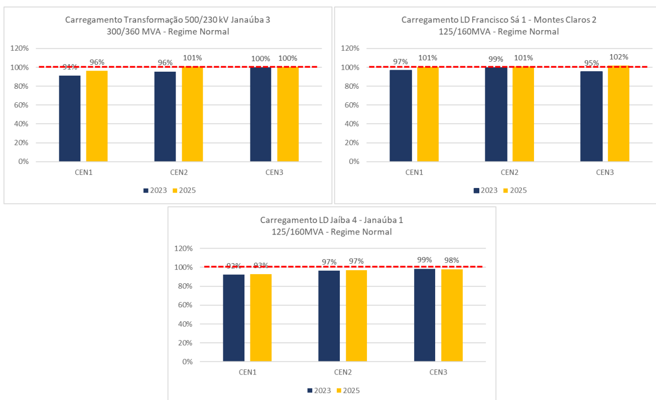
Figura 7-1 – Carregamentos em condição normal – com 3º TR
